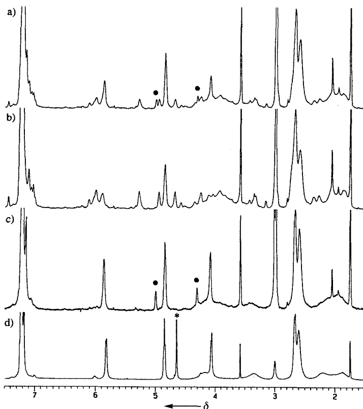
Abb. 3. ^1\text{H} -NMR-Spektren (500.133 MHz, [\text{D}_8]\text{THF} , -75^\circ\text{C} ) a) einer photolytierten Lösung von 2 \cdot 4 unmittelbar nach dem Aufwärmen von -196^\circ\text{C} auf -75^\circ\text{C} und b) 30 min später sowie c) des Hemiacetalplexes 2 \cdot 1 und d) des Benzol-Hemiacetalplexes 2 \cdot 10 . Die mit einem schwarzen Punkt und einem Stern markierten Signale stammen von incarcerated 1 bzw. Benzol.
